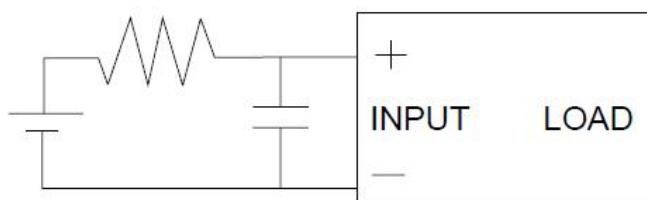
d) 推荐的使用电路，输出端的尖峰电压可能会引起 SSR 误动作，所以请在输出端加 R/C 回路或压敏电阻吸收尖峰电压，具体见下图：
